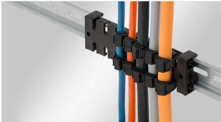
ストレインリリーフプレートKZLは、機械・制御盤・エナジーチェーン上に、スタティックケーブルやダイナミックケーブルといった様々なケーブルを配線するための製品です。櫛状のアンダーカットが、ケーブルタイ（結束バンド）をしっかりとホールドします。
